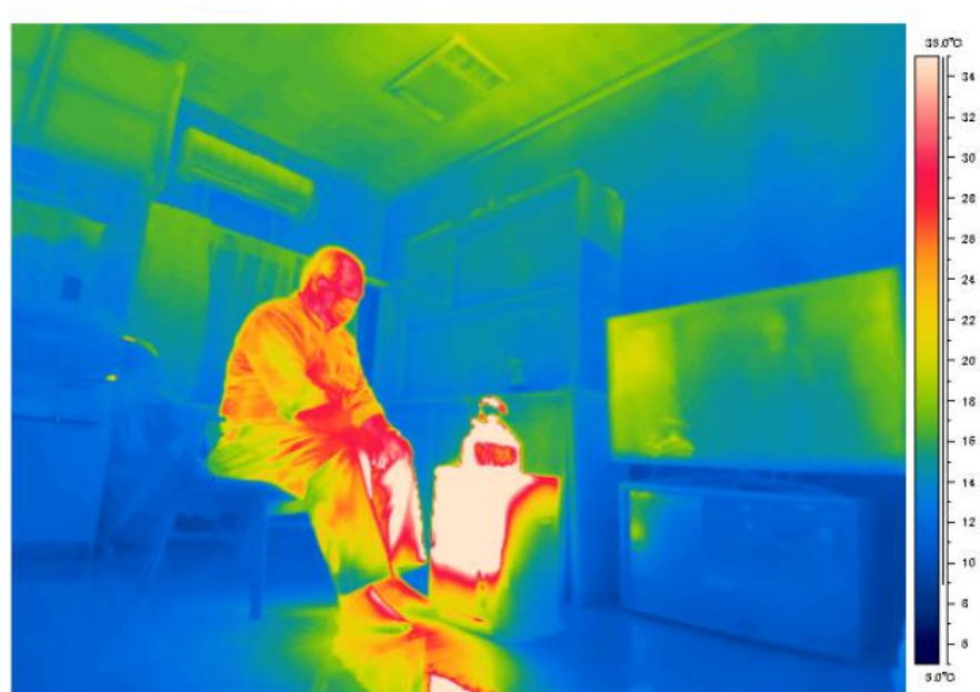
断熱+気密改修前
