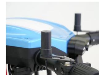
高精度で位置情報を測定できるRTKに対応し、センチメートル単位の測位精度を確保。GPS単独の測位よりも誤差が少なく、正確なルート飛行や均一な農薬散布が可能になります。
