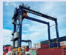
大井ふ頭で実荷役作業を行うトランスターナ
