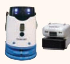
レーザーと超音波センサーで周囲の障害物を正確に検知しながら、自動運転で床を清掃
