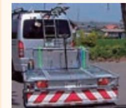
電波・通信技術を活用した地下センシング技術で、地下の埋設物や空洞を探索
