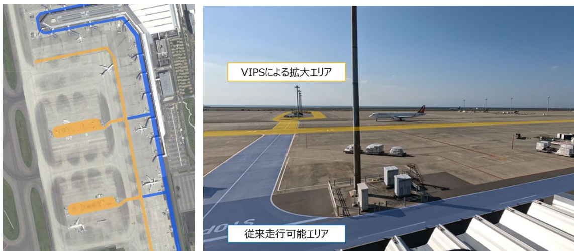
「VIPS」による空港内の自動運転可能エリアの変化 ※左図: 国土地理院撮影の空中写真(2010年撮影)を加工して作成
