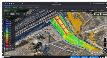
ICT土工による土量の自動管理
