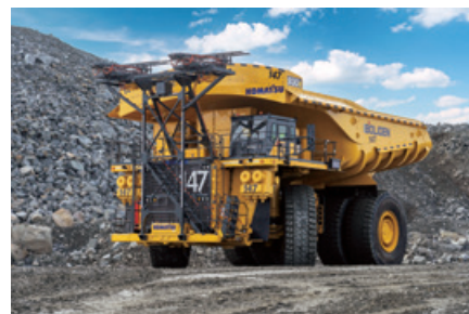
【Boliden社の銅鉱山で稼働するディーゼル・トロリー式930Eパワーアグノスティックトラック】
