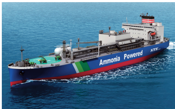
日本郵船殿 ご建造AFMGC* *アンモニア燃料アンモニア輸送船 (2026年11月 就航予定)
