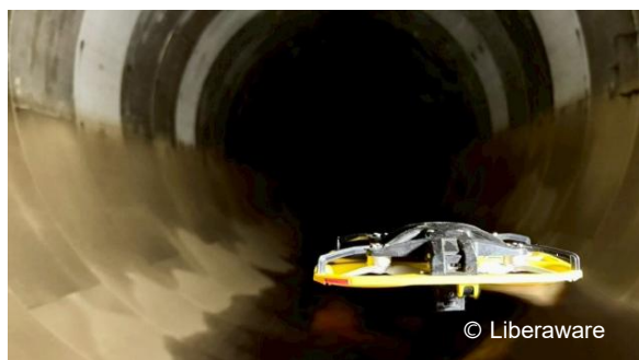
下水道管の中を飛行する小型ドローン「IBIS2」
