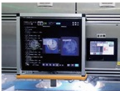
AIを活用した自動選別機。上のカメラでチーズのはみ出しや形状、コンペヤの下のカメラより製造日の印字、斜め上のカメラよりシユリンクの破れなどを検査
