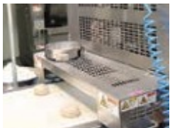
生地を同量に切り分け、丸める、職人同様の技術での成形自動化
