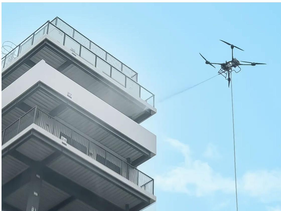
モリタ ATI センターでの、ドローンを使った放水実験の様子
