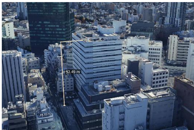
3Dmapspocket®による計測イメージ(左:高精度 3 次元点群データ／右:Google Photorealistic 3D Tiles)
