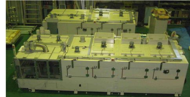
直交ロボット搬入出連続搬送炉
