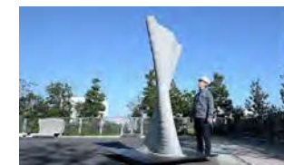
材料噴射型3Dコンクリートプリンティングシステムで造形したねじれ壁
