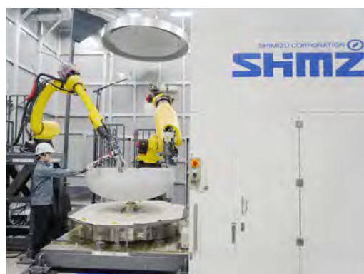
金属3D積層装置を用いて直径1.5mの大型タンクを製造
