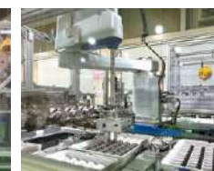
生産工程の自動化(NXTRベッド裏面ローラーAssy自動機)
