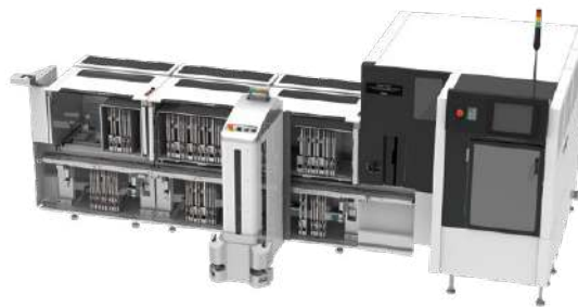
テーブルロール装填工程を自動化する業界初の「オートキッキングステーション」
